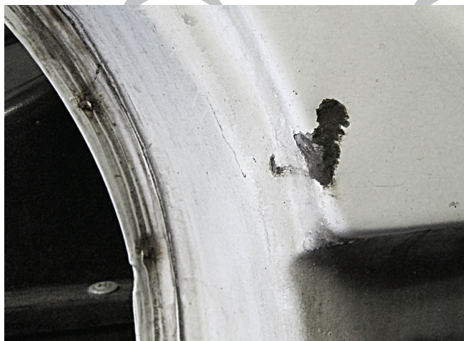
Фото 2.7 Сколы краски на передней стойке автомобиля «Ока»
