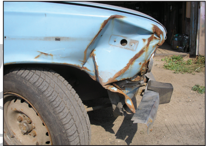
Фото 2.5 А - вмятины на капоте и крыле автомобиля Ваз - 2107, Б - смятое крыло автомобиля Ваз - 2106
