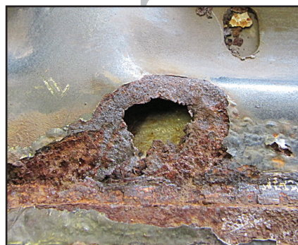
Фото 2.4. Сквозная коррозия на внутренней стороне капота автомобиля «Дэу-Нексия»
