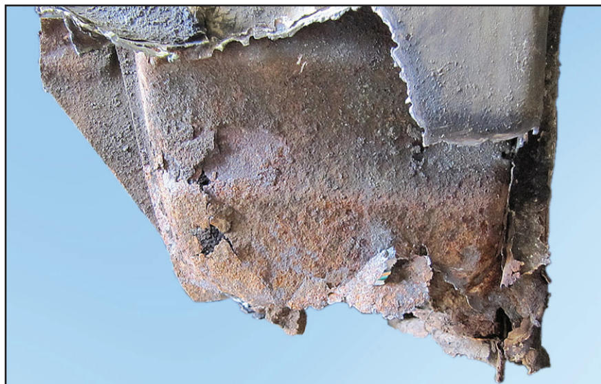
Фото 2.2. Фатальная коррозия нижней части передней стойки автомобиля Ваз - 11113 «Ока»
